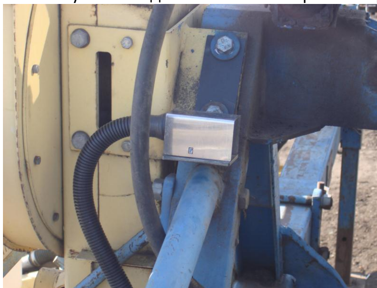
Рисунок 9. Установка кронштейна разъема на треугольнике сеялки СТП-12 «РИТМ-1М»
