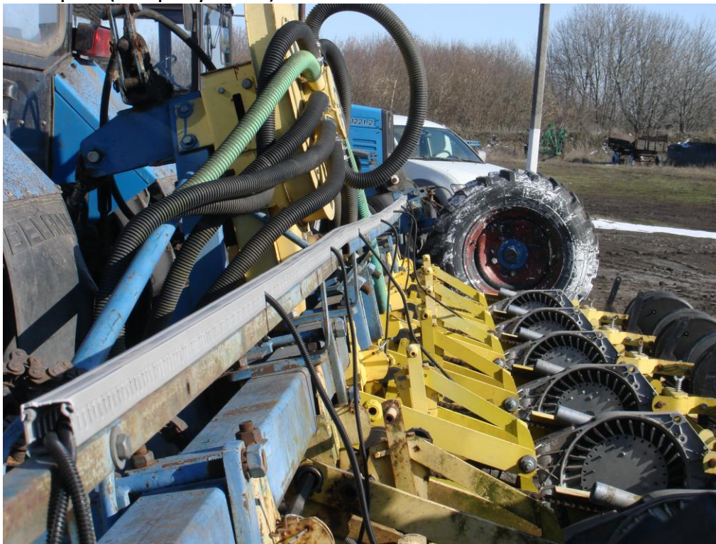
Рисунок 8. Жгут в коробе на сеялке СТП-12 «РИТМ-1М».
