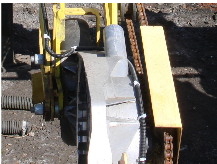
Рисунок 10. Петля провода при переходе с высевающего аппарата на рычаг. Сеялка СТП-12 «РИТМ-1М»
